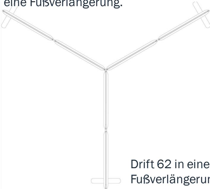
Drift 62 in einer 3 x 120° Verbindung benötigen Fußverlängerungen an jedem zweiten Element
