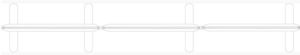
Die Elemente des Drift 62 können mit Verbindungsbügeln linear verbunden werden. Das erste Element benötigt zwei Fußverlängerungen. Alle weiteren Elemente benötigen nur eine Fußverlängerung.
